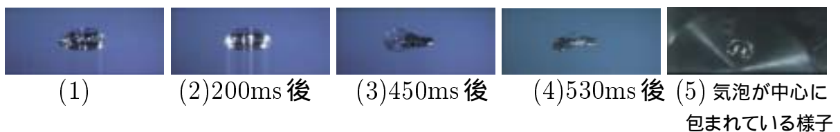
図9 グリセリン液滴に気泡が混入する様子
